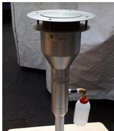
Utilisée en extérieur, cette tête de prélèvement mesure la concentration de particule fines dans l'air.
